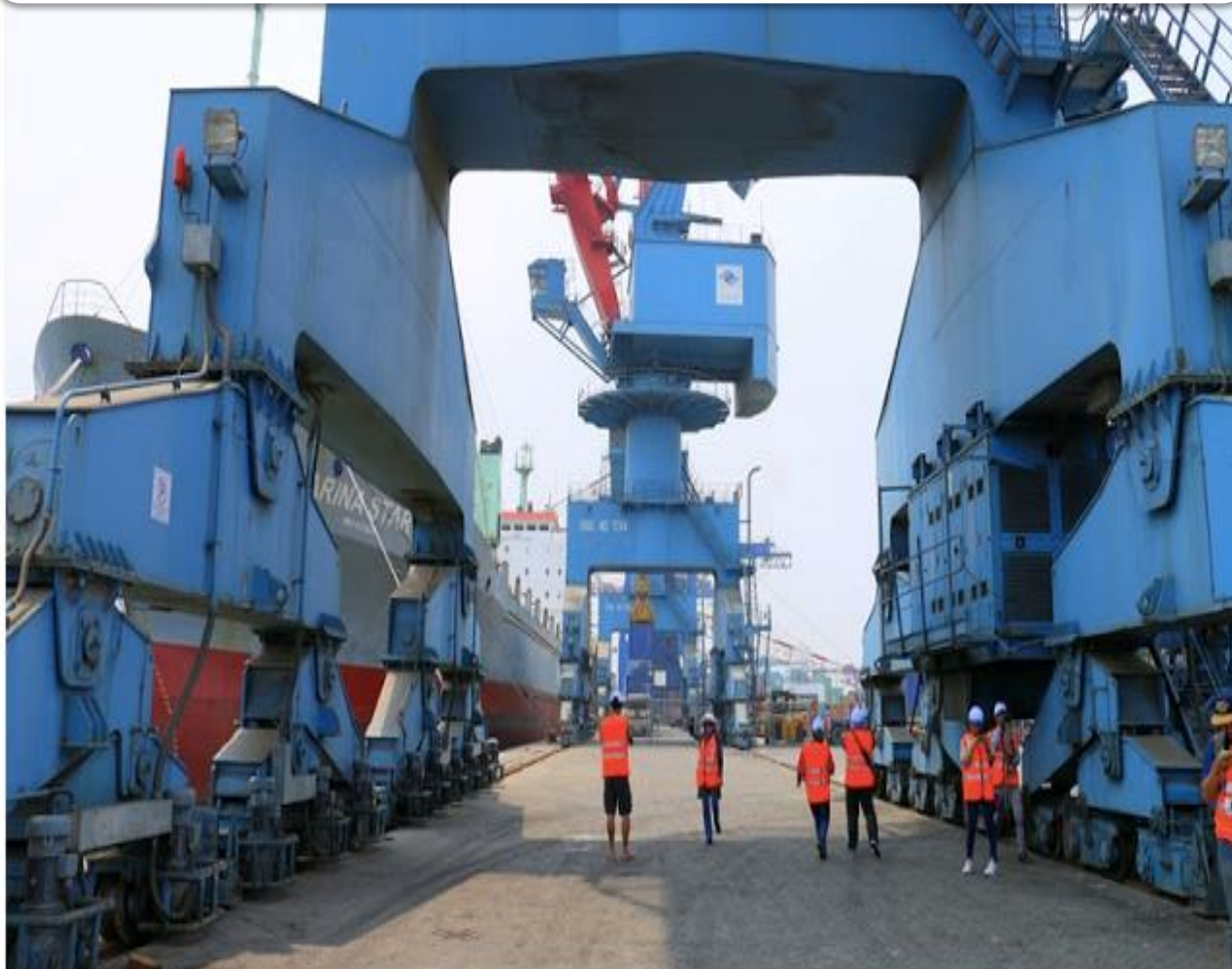
Di bawah Gantry Luffing Crane, alat penunjang stevedoring
